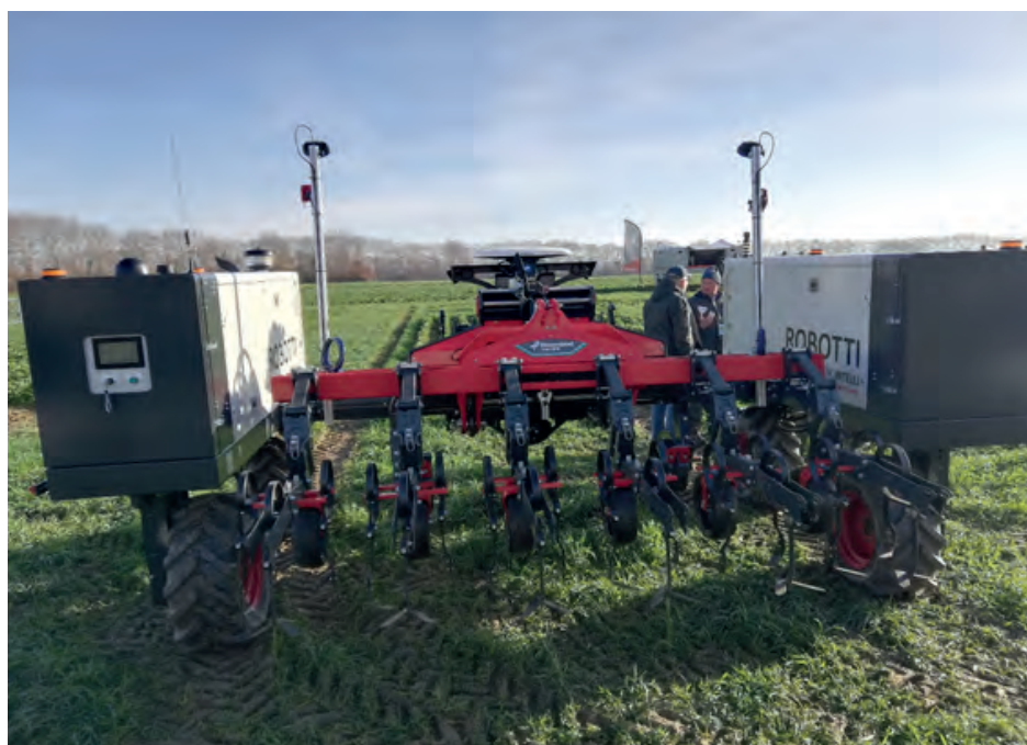
Plataforma móvil autónoma Robotti, que puede trabajar con cualquier máquina convencional
